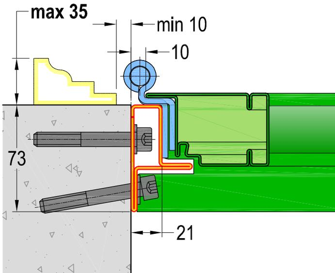
Telaio tipo **B** montato internamente senza controtelaio
