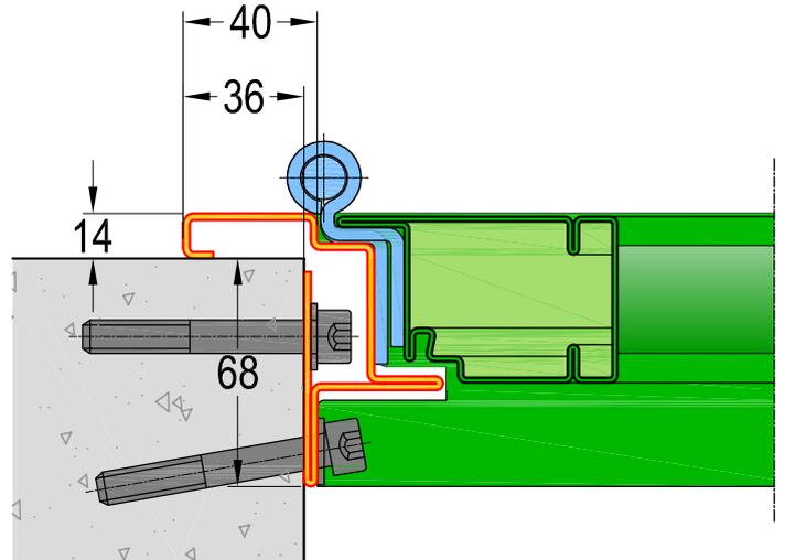
Telaio tipo **B** montato a filo muro con controtelaio
