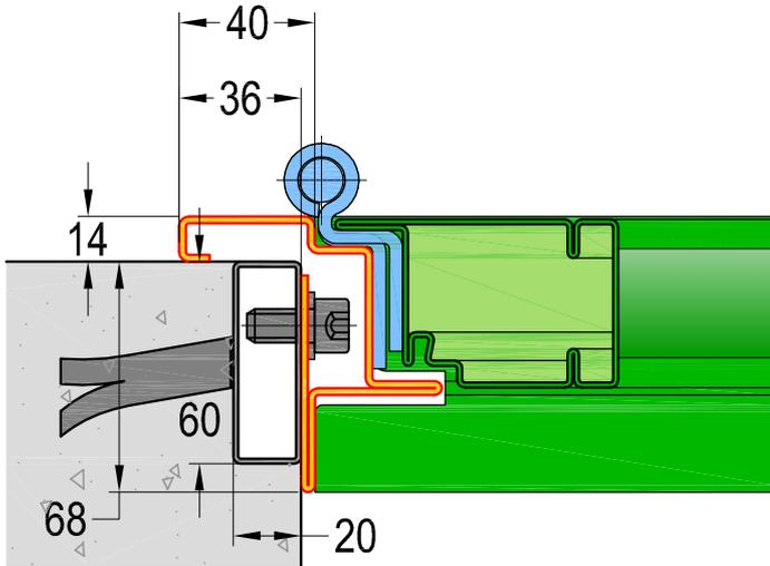
Telaio **STANDARD** senza controtelaio
