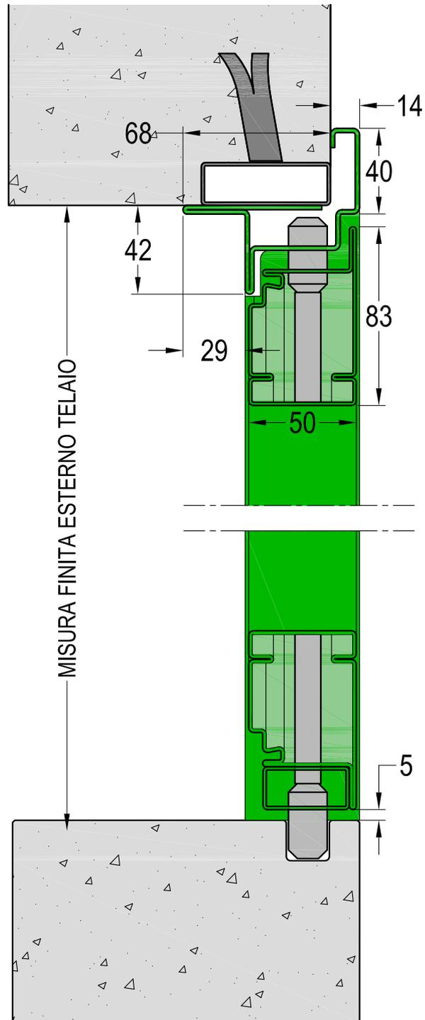
Telaio **STANDARD** con controtelaio
