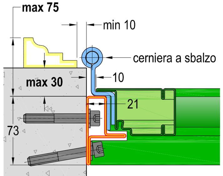
Telaio tipo **C** con controtelaio
