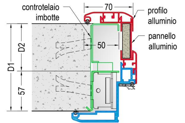
4a. Soluzione con imbotte in alluminio in luce con controtelaio
