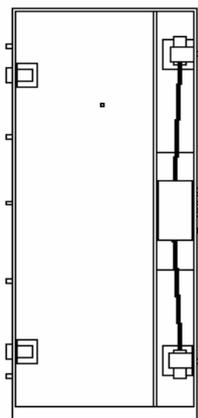
(1)Hauteur maximale de 2450 avec installation obligatoire d'une troisième paumelle et supplément de 20% sur le prix totale de la porte hors standard.
