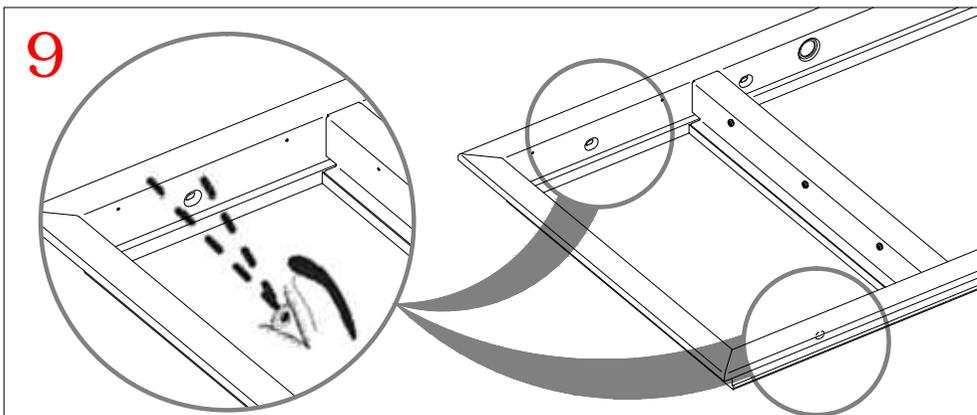
**NOTA!** PRIMA DI MONTARE IL VETRO VERIFICARE CHE LA ZONA DEI MONTANTI TRA LE DUE TRAVERSE NON CONTENGA I FORI DI FISSAGGIO AL CONTROTELAIO. ALTRIMENTI PROCEDERE PRIMA AL POSIZIONAMENTO DEL TELAIO SUL CONTROTELAIO. VEDERE FASI 4...9 DEL FOGLIO «ASSEMBLAGGIO TELAIO SOLUZIONE "A" »
